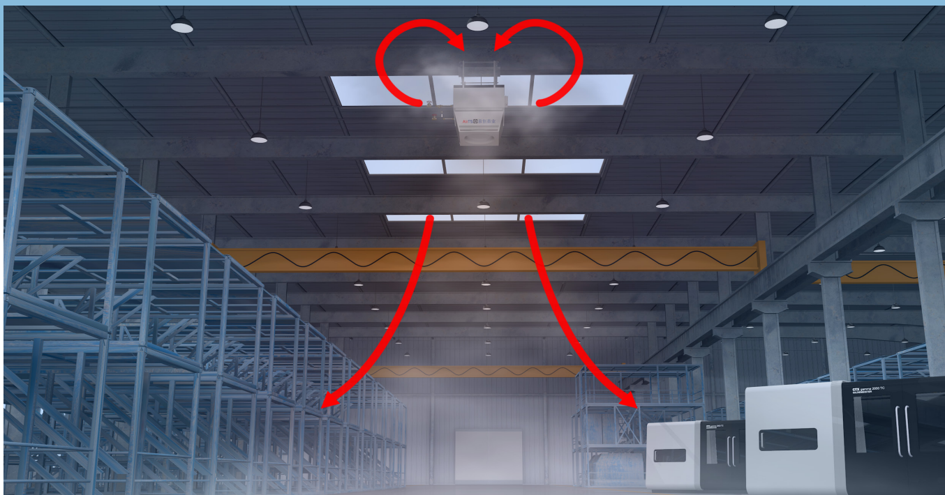
Воздух, нагнетаемый вентилятором, проходит через нагреватель, нагревается и подается в помещение при помощи воздухораспределителя AirTS
